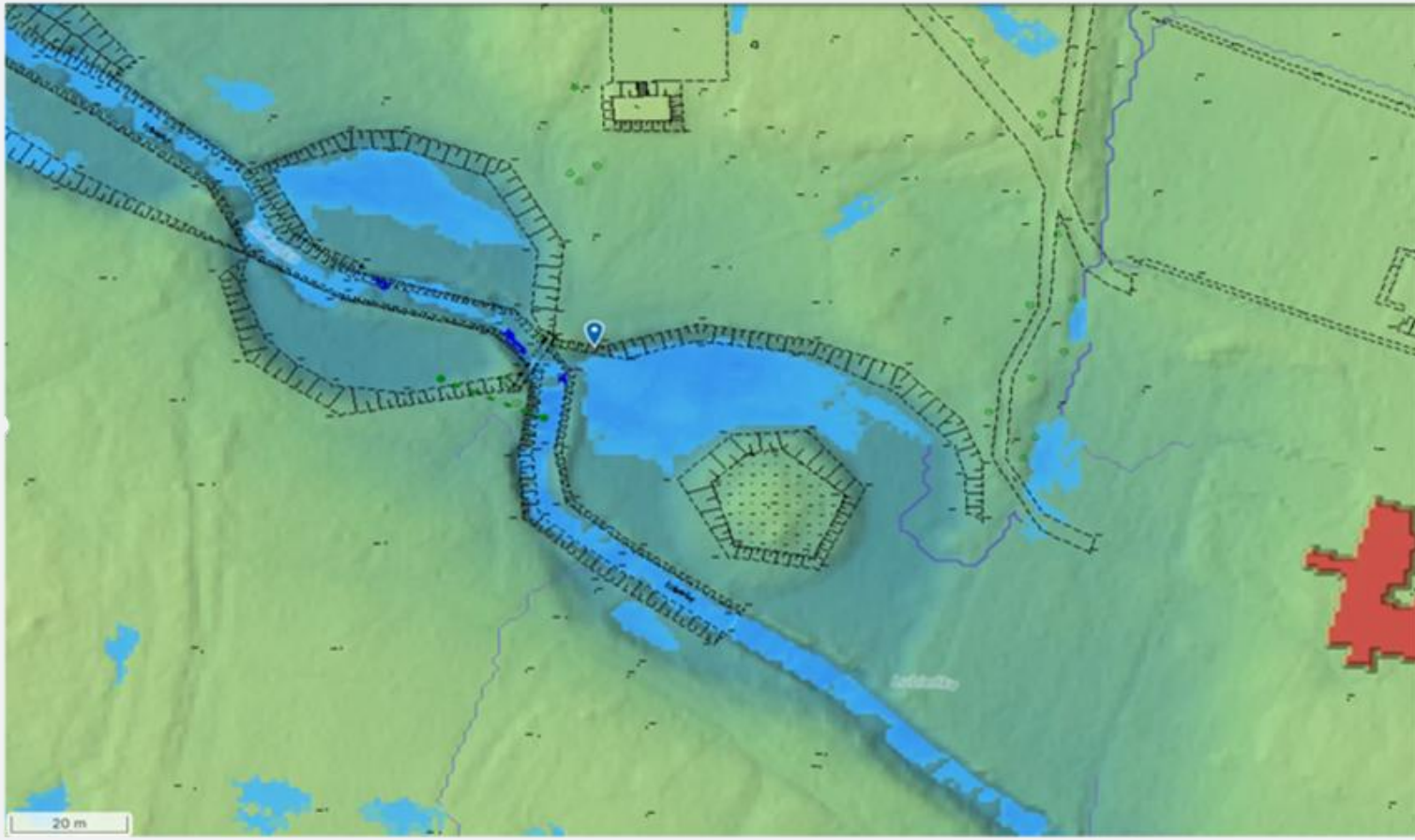
Ryc. 6.4.1.2. Rzeka Lubienka w miejscu planowanej odbudowy (dz. 136/1) – rzędna lustra wody na podpietrzeniu 91.587 m n.p.m. (52°31'04.6204"N·19°01'00.9718"E).¶
